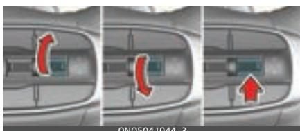
Lai atsāktu manuālās ātruma ierobežošanas palīgsistēmas darbību pēc tās iepauzēšanas, nospiediet +, -, (⌚) slēdzi. Ja nospiežat + slēdzi uz augšu vai - slēdzi uz leju, automobiļa ātrums tiks iestatīts uz mērinstrumentu paneli tobrīd redzamo.
