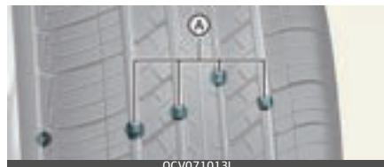
A: Protektora nodiluma indikators
