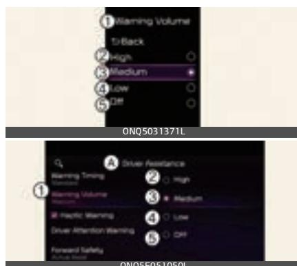
**A: Vadītāja palīgsistēma****1 Brīdinājuma skaļums****2 Augsta****3 Vidēja****4 Zems****5 Off** (Izslēgts) (Ja aprīkojumā ir stūres vibrācijas funkcija.)
