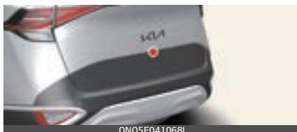
Atpakaļskata kamera kalpo kā atklāšanas sensors, lai atpazītu gājējus. Ja kameras lēca ir pārklāta ar svešķermeņiem, kā sniegu vai lietu, tas var negatīvi ietekmēt kameras sniegumu, un parkošanās atpakaļgaitā pretsadursmju palīgsistēma var nedarboties normāli.
