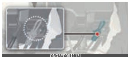
Ārkārtas gadījumā pārgrieziet apkopes intervālu savienotājkabeli, lai atslēgtu augstsprieguma akumulatoru.
