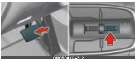
Nospiediet (⌚) slēdzi, lai uz laiku iepauzētu iestatīto ātruma ierobežojumu. Iestatītais ātruma ierobežojums izslēgjies, bet ātruma ierobežojuma indikators (LIMIT) paliks degam.
