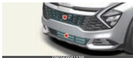
Aktīvais gaisa aizvars kontrolē gaisa aizvaru, kas atrodas zem priekšējā bufera, lai dzesētu automobiļa daļas un uzlabotu energoefektivitāti.
