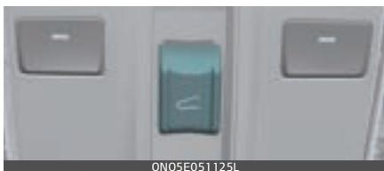
Jumta lūku var darbināt, tikai ja aizdedzes slēdzis vai poga ENGINE START/STOP ir ON vai START pozīcijā.
