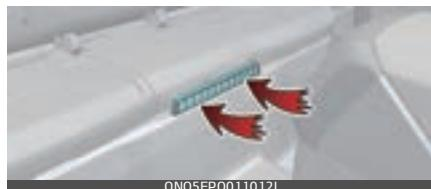
Hibrīdakumulatora dzesēšanas kanāls atrodas zem aizmugures sēdekļa. Dzesēšanas kanāls dzesē hibrīdakumulatoru. Ja hibrīdakumulatora dzesēšanas kanāls ir bloķēts, hibrīdakumulators var pārkarst.
