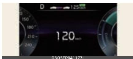
Ja gaidīšanas stāvoklī ir nepieciešama pagaidu palēnināšanās un darbojas uz navigācijā bāzētā viedā kruīza kontrole, mērinstrumentu blokā iedegas zaļais (NAU) simbols.
