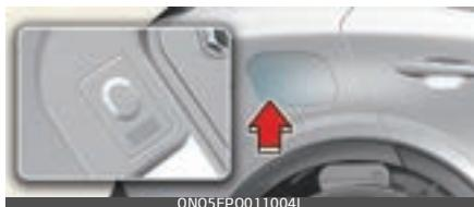
Varat pārbaudīt uzlādes statusu ārpus automobiila, kad uzlādējat akumulatoru vai izmantojat (tas nav braukšanas stāvuss) augstsrieguma akumulatoru.
