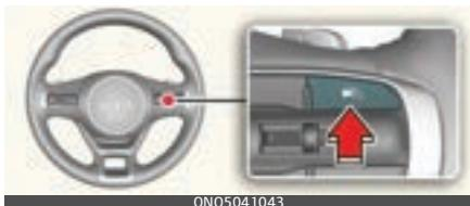
Nospiediet braukšanas palīgsistēmu (➡) pogu, lai izslēgtu manuālās ātruma ierobežošanas sistēmu. Ātruma ierobežojuma indikators (LIMIT) nodzīsīs.
