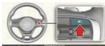
Nospiediet braukšanas palīgsistēmu (✉) pogu, lai ieslēgtu šo funkciju. Ātrums tiks iestatīts uz tobrīd mērinstrumentu panelī parādīto ātrumu.
