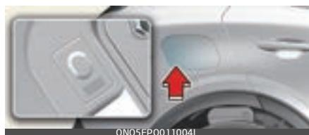
Varat pārbaudīt uzlādes statusu ārpus automobiļa, kad uzlādējat akumulatoru vai izmantojat (tas nav braukšanas statuss) augstsprieguma akumulatoru.
