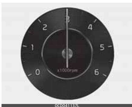
Tahometrs rāda aptuveno motora apgriezienu skaitu minūtē (apgr./min.).
