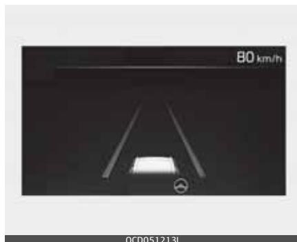
Ja priekšā tiek konstatēts transportlīdzeklis vai abi līniju markējumi, un jūsu automobiļa kustības ātrums ir mazāks par 180 km/h, mērinstrumentu blokā iedegsies zaļš (⌚) indikators, un funkcija palīdzēs centrēt automobili joslā, kontrolējot stūri.
