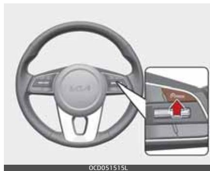
1. Nospiediet braukšanas palīgsistēmu pogu, lai ieslēgtu sekošanas joslai palīgsistēmu. Mērinstrumentu blokā iedegsies indikators CRUISE.
