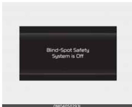
Ja motors tiek atkal iedarbināts ar izslēgtu funkciju, mērinstrumentu blokā parādīsies pazīņojums "Blind-Spot Safety System is Off" (Aklā punkta drošības sistēma ir izslēgta).
