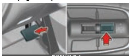
Nospiediet ( ↗) slēdzi, lai uz laiku iepauzētu iestatīto ātruma ierobežojumu. Iestatītais ātruma ierobežojums izslēgjies, bet ātruma ierobežojuma indikators (LIMIT) paliks degam.
