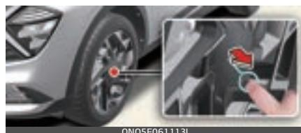
19 collu ritenim izņemiet Tire Mobility Kit esošo noņemšanas instrumentu. Ievietojiet instrumentu atverē un novelciet riteņa uzliku.
