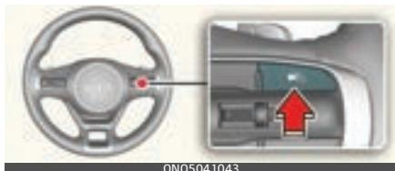
Mērinstrumentu blokā iedegsies ātruma ierobežojuma indikators (LIMIT).
