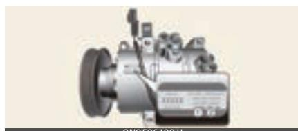
Kompresora uzlīme informē par automobilī izmantotā kompresora veidu, tā modeli, piegādes daļas numuru, izgatavošanas numuru, dzesēšanas līdzekli (1) un aukstumaģenta eļļu (2).
