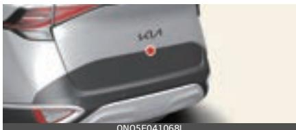
Atpakaļskata kamera kalpo kā atklāšanas sensors, lai atpazītu gājējus. Ja kameras lēca ir pārklāta ar svešķermeniem, kā sniegu vai lietu, tas var negatīvi ietekmēt kameras sniegumu, un parkošanās atpakaļgaitā pretsadursmju palīgsistēma var nedarboties normāli.
