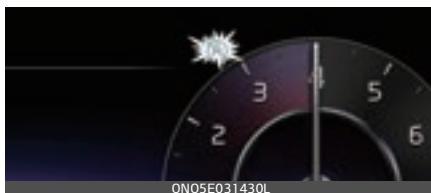
Uz ISG sistēmu norāda AUTO STOP indikators (A) mēriinstrumentu panelī.
