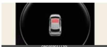
Kad vadītājs izslēdz motoru un jumta lūka nav pilnībā aizvērta, brīdinājuma signāls skanēs vairākas sekundes, un panela LCD ekrānā parādīsies brīdinājums par atvērtu jumta lūku.
