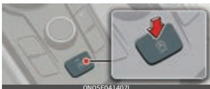
Ja vēlaties deaktivizēt ISG sistēmu, nospiediet pogu ISG OFF. Lampiņa uz pogas ISG OFF iedegas. Ja nospiežat pogu ISG OFF vēlreiz, sistēma tiks aktivizēta, un indikators uz pogas ISG OFF nodzīsīs.
