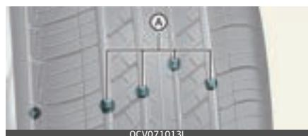
A: Protektora nodiluma indikators
