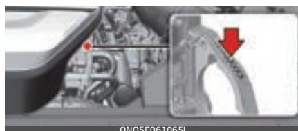
Motora numurs ir iespiests uz motora bloka, kā parādīts zīmējumā.
