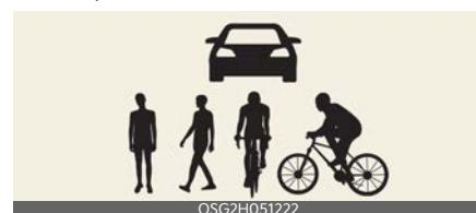
Augstāk redzamajā ilustrācijā parādīts attēls, ko priekšējā skata kamera un priekšējais radars spēj konstatēt kā automobili, gājēju un velosipēdistu.
