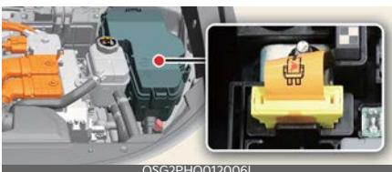
Ārkārtas situācijā nolaidiet dzelteno sviru servisa bloķešanas savienotājā, lai atvienotu augstu spriegumu no akumulatora. Servisa bloķešanas savienotājs netiek pilnībā izņemts.
