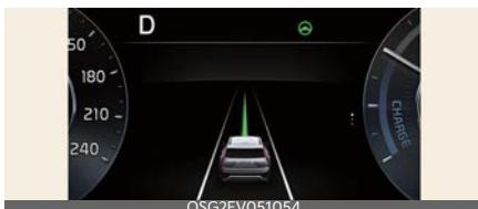
Ja tiek atpazīts priekšā esošs automobilis un/vai joslu markējumi un jūsu automobiļa ātrums nepārsniedz 160 km/h (90 jūdzes/h), panelī parādās zaļā indikatora lampiņa (⌚), un joslas saglabāšanas palīgsistēma palīdz noturēt automobilijoslā, nodrošinot stūrēšanas palīdzību.
