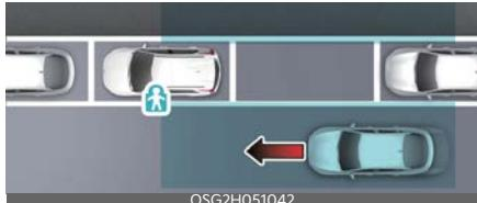
Jā tiek konstatēts automobilis, kas tuvojas automobilim pēc tā apstāšanās, pēc tam, kad pasažieris atver durvis, drošas izkāpšanas palīgsistēma brīdinātāju, izmantojot brīdinājuma ziņojumu un skanas brīdinājumu, lai palīdzētu novērst sadursmi.
