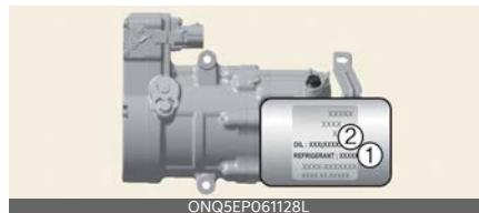
Kompresora markējums ietver informāciju par kompresoru, kas uzstādīts jūsu automobilī, piemēram, modeli, piegādātāja detaljas numuru, ražošanas numuru, dzesētāju (1) un dzesētāja eļļu (2).
