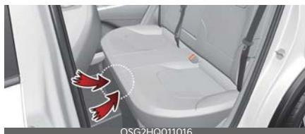
Hibrīda akumulatora dzesēšanas cauruļvads atrodas zem aizmugurējiem sēdekļiem. Dzesēšanas cauruļvads dzesē hibrīda akumulatoru. Ja hibrīda akumulatora dzesēšanas cauruļvads ir bloķēts, hibrīda akumulators var pārkarst.
