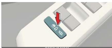
Ja elektroniskā bērnu drošības slēdža poga atrodas pozīcijā LOCK (bloķēts) un tiek atpazīts automobilis, kas tuvojas no aizmugures, elektroniskā bērnu drošības slēdža (
