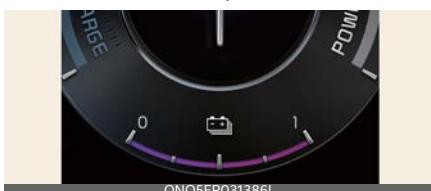
Šī mērīerce norāda atlikušo hibrīda akumulatora uzlādi. Ja uzlādes stāvoklis ir tuvu līmenim "0 (Zems)", automobilis automātiski darbina dzinēju, lai uzlādētu akumulatoru.
