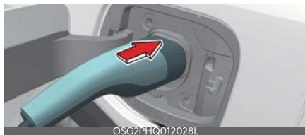
levietojiet lādētāju uzlādes ieejas atverē, līdz atskan klikšķis. Ja savienotājs nav pilnībā pievienots, nepareizs savienojums starp uzlādes savienotāju un uzlādes spailēm var izraisīt ugunsgrēku.
