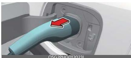
Lai novērstu uzlādes kabeļa zādzības iespēju, uzlādes savienotāju nav iespējams atvienot no ieejas, kamēr automašīnas durvis ir aizslēgtas.
