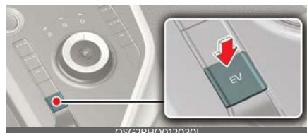
Nospiežot pogu EV, pie elektrotīkla pieslēdzamā hibrīda automobiļa režīms pārslēgsies šādā secībā: automātiskajā (AUTO) režīmā — hibrīda (CS) režīmā — elektriskajā (CD) režīmā. Nospiediet un turiet nospiestu EV pogu, lai pārslēgtos uz EV+ režīmu.
