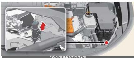
Ja uzlādes savienotājs kāda iemesla dēļ neatbloķējas, atveriet pārsegu un nedaudz pavelciet avārijas kabeli, kā
