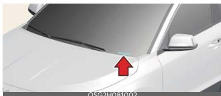
Transportlīdzekļa identifikācijas numurs (Vehicle Identification Number — VIN) ir numurs, kas tiek izmantots transportlīdzekļa reģistrēšanai, kā arī jebkādu juridisku jautājumu risināšanai saistībā ar īpašumtiesībām utt.
