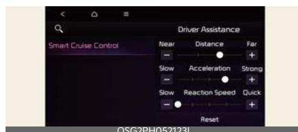
Lai iestatītu attālumu, paātrinājumu un reaģēšanas ātrumu, dzinējam esot ieslēgtam, instrumentu panelī pieskarieties **Iestatījumi** → **Palīdzība vadītājam** → **Braukšanas ērtība** → **Viedā kruīza kontrole** vai instrumentu panelī pieskarieties **Iestatījumi** → **Automobilis** → **Palīdzība vadītājam** → **Braukšanas ērtība** → **Viedā kruīza kontrole**.
