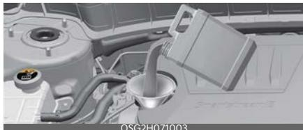
Izmantojiet piltuvi, lai izvairītos no eļļas izlīšanas uz dzinēja komponentiem.
