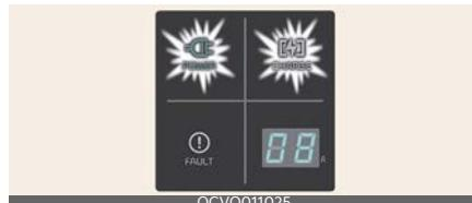
9. Pārbaudiet vai uzlādes indikators (⚡) augsts prieguma akumulatoram instrumentu panelī ir ieslēgts. Uzlāde nenotiek, ja uzlādes indikators (⚡) ir OFF (izslēgts). Ja uzlādes savienotājs nav pareizi pievienots, atkārtoti pievienojiet uzlādes kabeli, lai veiktu uzlādi.
