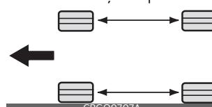
Lai izlīdzinātu protektoru nodilumu, ieteicams rotēt riepas ik pēc 10 000 km (6500 jūdzēm) vai ātrāk, ja konstatēts nevienmērīgs nodilums.
