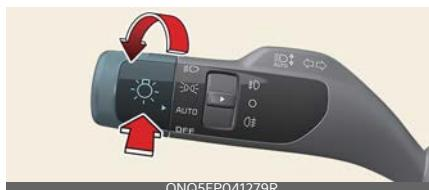
Tālo gaismu palīgsistēma ir funkcija, kas automātiski pielāgo priekšējo lukturu diapazonu (pārslēdz starp tālajām un tuvajām gaismām) atkarībā no konstatēto transportlīdzekļu spilgtuma un konkrētajiem apstākļiem uz ceļa.
