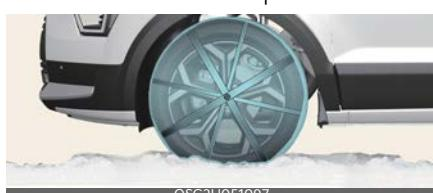
Tā kā radiālo riepu sānu sienīņas ir plānākas, tās iespējams sabojāt, uz tām uzstādot riepu kēdes. Tādēļ ieteicams riepu kēžu vietā lietot ziemas riepas. Neuzstādīt riepu kēdes automobilijem,
