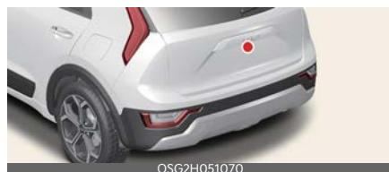
Platlenķa kameras tiek izmantotas kā atpazīšanas sensori gājēju atpazīšanai. Ja kameras lēcu sedz nepiederoši materiāli, piemēram, sniegs vai lietus, tas var negatīvi ietekmēt kameras veikspēju un stāvvietas sadursmes novēršanas palīgsistēma var nedarboties pareizi. Kameras lēcā vienmēr jābūt tīrai.
