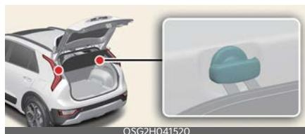
3. Turot kravas zonas aizsarga vadu (2), ievietojiet to augšējā āķī, kas atrodas zem aizmugurējā stikla, un izmantojet to, lai nostiprinātu.
