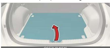
1. Satveriet rokturi pārsega augšpusē un paceliet to.
